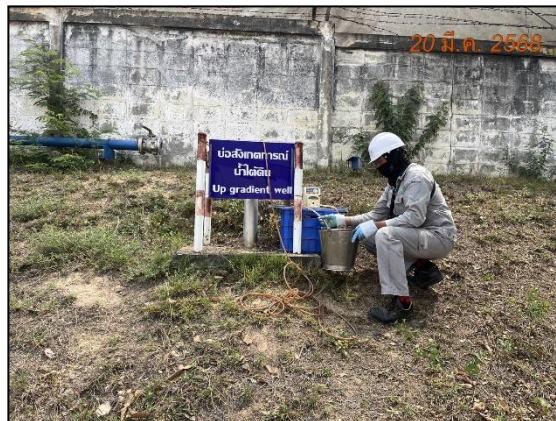
รูปที่ 3.12 การเก็บตัวอย่างคุณภาพน้ำใต้ดิน บริเวณ บ่อสังเกตการณ์ต้นน้ำ (UW1)
